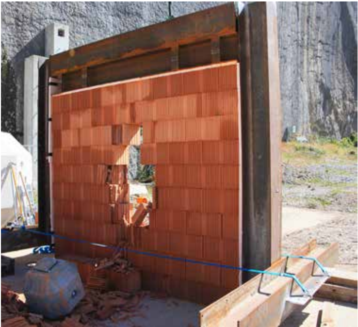
Étude de la vulnérabilité à l’impact d’un mur en maçonnerie. © Univ. Eiffel
